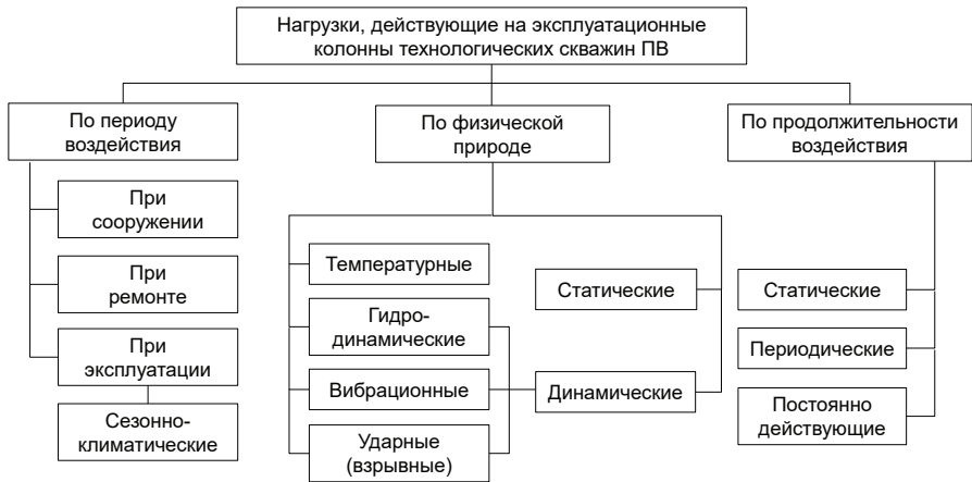
Рис. 1. Классификация нагрузок, действующих на ЭК технологических скважин СПВ урана
